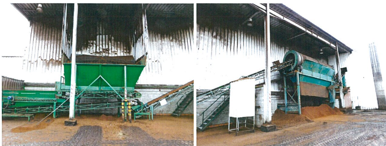
Figura 2 – Sistema de pré-crivagem para separação de resíduos (esquerda) e separação do pó de casca (direita).
